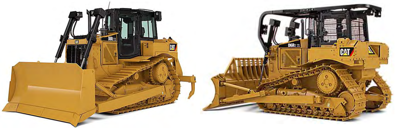
Рис. 17.1 - Зображення гусеничного бульдозеру CATERPILLAR модель D6R2
