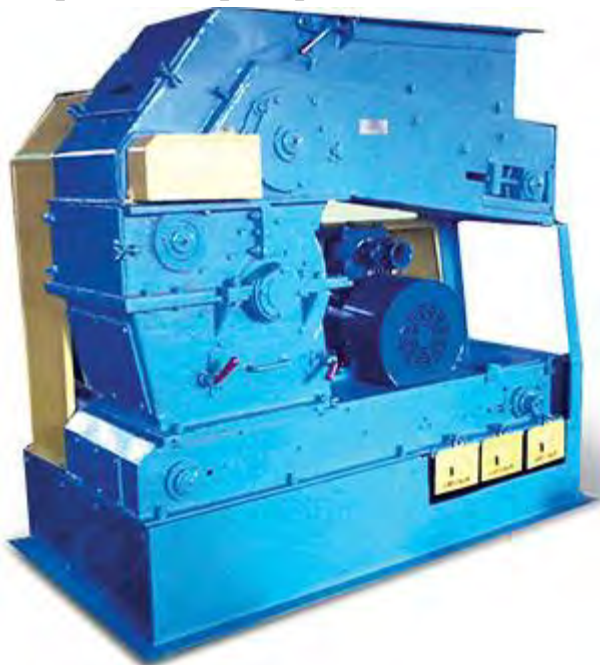
Рис. 17.2 - Проборозділювальна машина МПЛ 150М2
